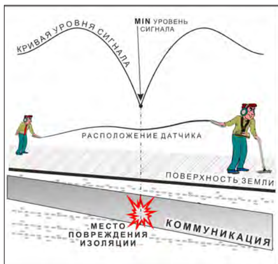
применение датчика-определителя дефектов коммуникации (ДОДК) методом min
