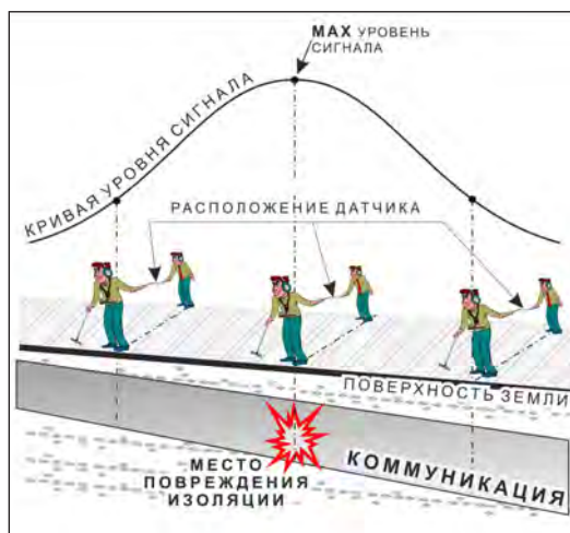
применение датчика-определителя дефектов коммуникации (ДОДК) методом max
